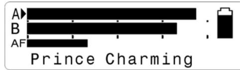
Fig:2 DISPLAYING THE USER ID TEXT.
